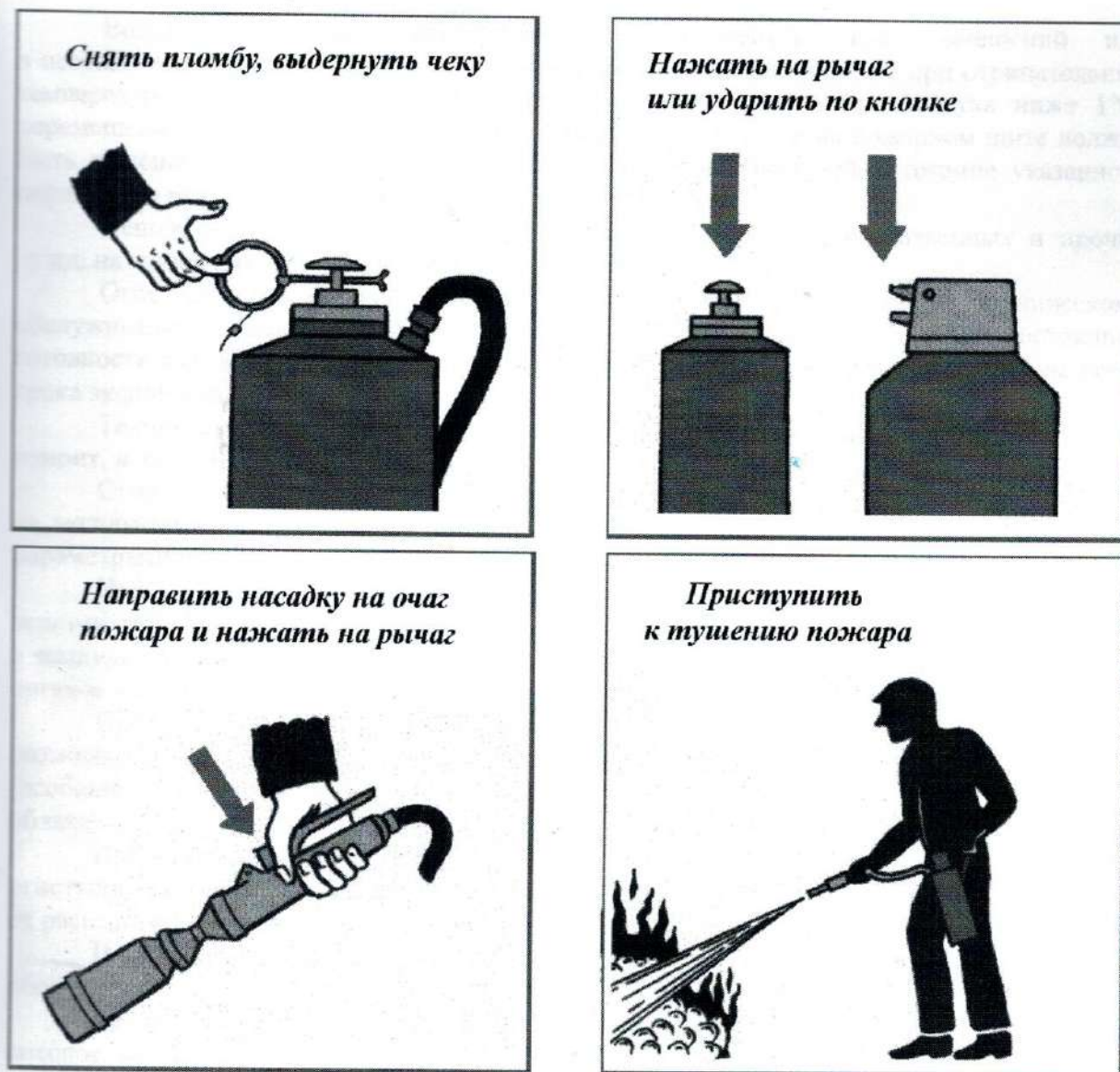
Рис. 9. Приведение в действие воздушно-пенного огнетушителя (плакат)
