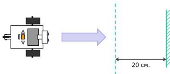
**6. Парковка.** Датчик расстояния смотрит в сторону. Робот должен найти пространство для парковки между двумя «автомобилями» и выполнить заезд в обнаруженное пространство.
