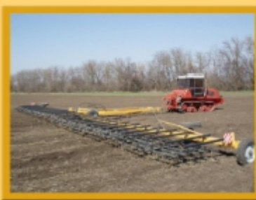
А это борона. Она с острыми зубьями, поэтому называется "зубовая". Борона разбивает крупные комья земли на мелкие. Бороной боронят землю.
