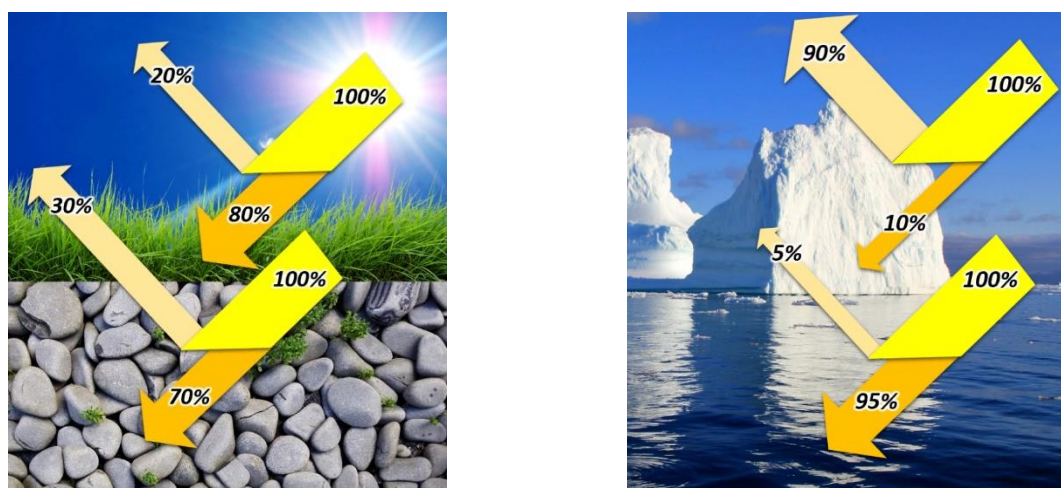
Рис. 3. Поглощение и отражение солнечной энергии разными поверхностями
