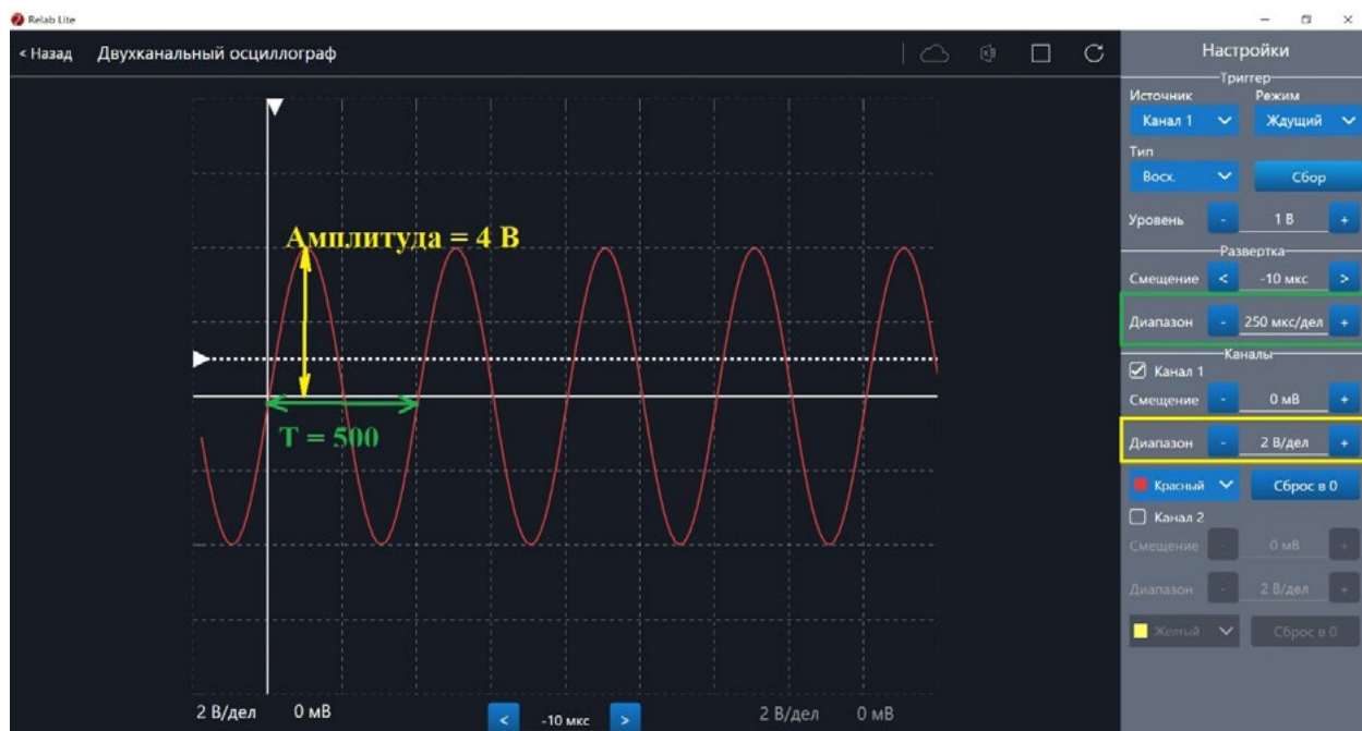
Рис. 42. Определение параметров осциллограммы
