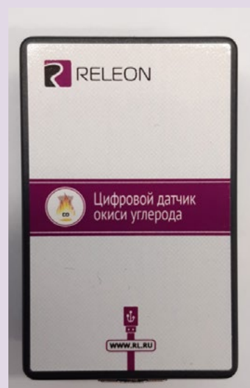
Рис. 11. Датчики кислорода (слева) и угарного газа (справа)
