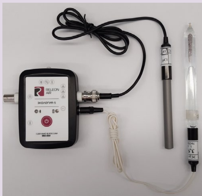
Рис. 10. Ионоселективный датчик (присоединены электроны хлорид-ионов и электрод сравнения)
