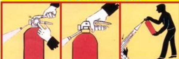
Снять огнетушитель, сорвать пломбу, выдернуть чеку. Привести раструб в горизонтальное положение и нажать на рычаг. Направить струю заряда на огонь.
