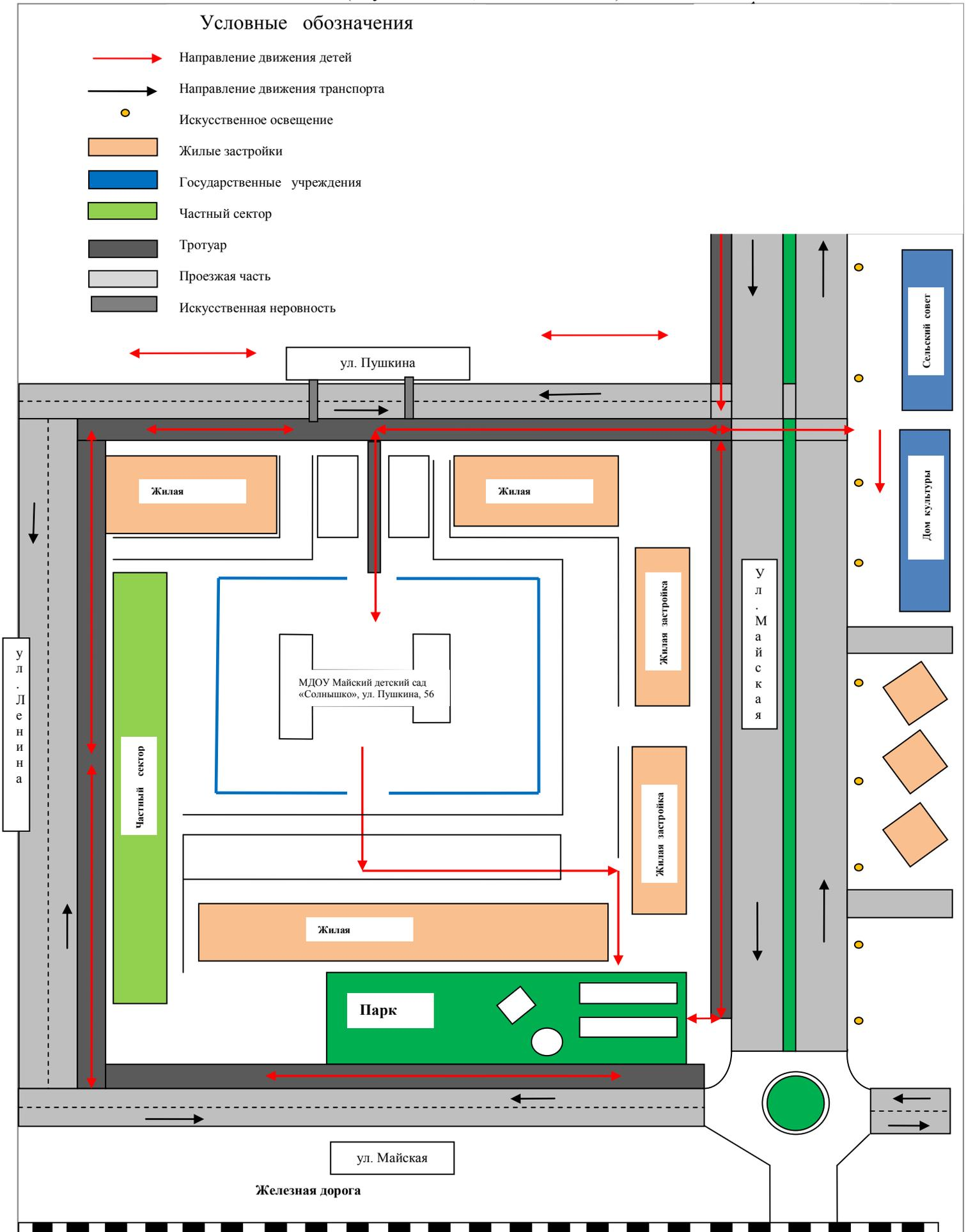
2. Схема организации дорожного движения в непосредственной близости от образовательного учреждения с размещением соответствующих технических средств организации дорожного движения.
