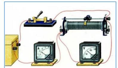
При движении ползунка реостата влево или вправо показания амперметра изменяются. График зависимости силы тока в цепи представлен на рисунке.
