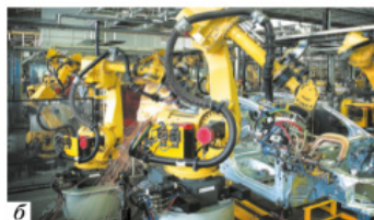
Рис. 10.2. Использование машиностроительных технологий: а — сборочный конвейер на автомобильном заводе; б — автоматическая линия на машиностроительном заводе
