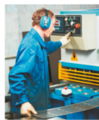
Рис. 5.25. Процесс резки металлического листа на гильотинных ножницах (станке)
