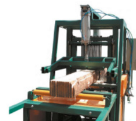
Рис. 4.7. Процесс распиловки бревна на лесопильном станке (пилоаме)
