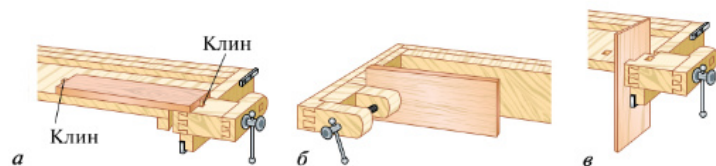
Рис. 4.3. Закрепление заготовки: а — для строгания на плоскости; б — в переднем зажиме; в — в заднем зажиме
