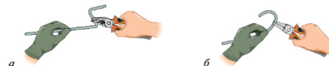
Рис. 5.14. Приёмы сгибания проволоки: а — плоскогубцами; б — круглогубцами
