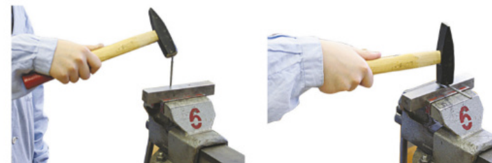
Рис. 5.13. Приёмы гибки проволоки в слесарных тисках с помощью стальной оправки
