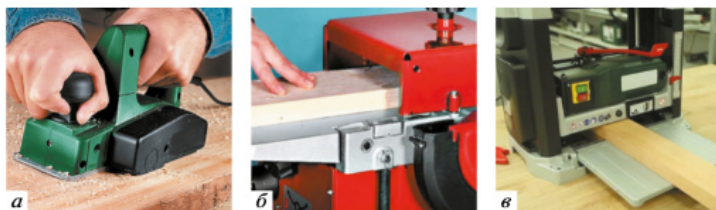
Рис. 4.26. Электрические инструменты и станки для строгания древесины: а — рубанок ручной; б — строгальный станок; в — рейсмусовый станок
