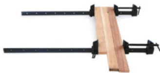
Рис. 4.43. Склеивание обрезных досок с использованием струбцин
