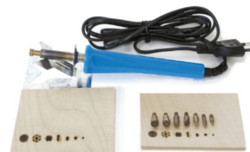
Рис. 8.4. Многоцелевой электровыжигатель со съёмными латунными насадками
