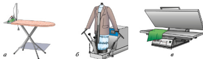
Рис. 6.13. Оборудование для ВТО: а — гладильная доска с утюгом; б — паровоздушный манекен; в — пресс для ВТО
