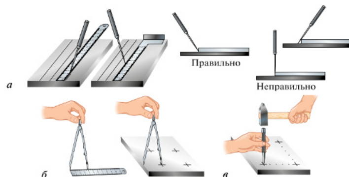
Рис. 5.7. Приёмы разметки: а — прямых линий; б — перенос размеров циркулем; в — накернивание молотком разметочных точек
