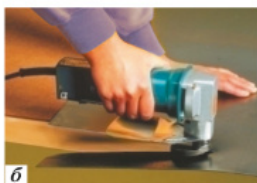
Рис. 5.23. Электрифицированные ножницы: а — внешний вид; б — использование при резании металла
