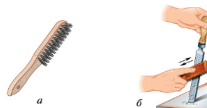
Рис. 5.38. Очистка напильника от стружки: а — корд-щётка; б — приёмы очистки
