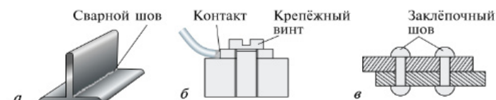
Рис. 5.43. Неподвижные соединения: а — сварное; б — винтовое; в — заклёпочное
