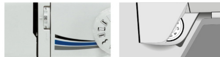
Рис. 6.13. Регуляторы натяжения верхней нити швейной машины
