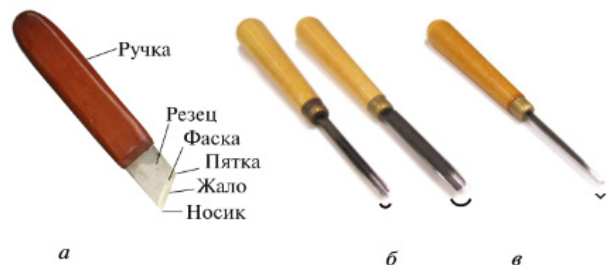
Рис. 8.3. Инструменты для контурной резьбы: а — нож-косяк; б — полукруглые стамески; в — стамеска-уголок
