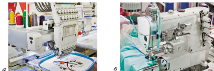
Рис. 6.11. Специальные швейные машины: а — промышленная вышивальная;
