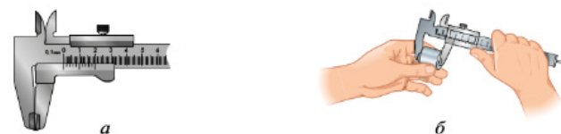
Рис. 5.14. Измерение штангенциркулем: а — проверка исправности; б — измерение
