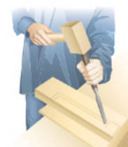
Рис. 4.54. Приём долбления на подкладной доске
