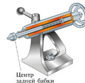
Рис. 5.44. Конусное соединение центра задней бабки
