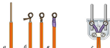
Рис. 11.3. Оконцевание многожильного провода колечком и крепление в контактном зажиме: а — зачистка провода; б — скручивание провода в кольцо; в — изолирование провода; г — крепление провода в контактных зажимах вилки
