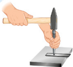
Рис. 5.21. Приём разрубания полосового металла на плите
