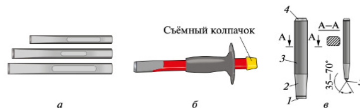
Рис. 5.15. Слесарные зубила: а — разновидности зубил; б — зубило с рукояткой для безопасной работы; в — основные части зубила: 1 — режущая часть (фаска); 2 — режущая часть (клин); 3 — средняя часть; 4 — ударная часть (боёк); 5 — угол заострения
