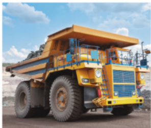
Рис. 3.1. Карьерный самосвал грузоподъёмностью 610 т
