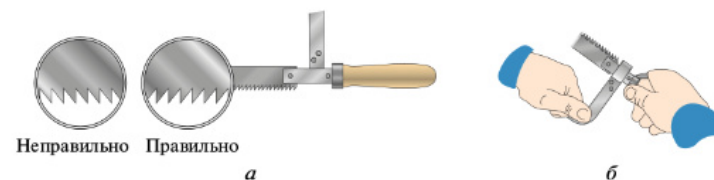
Рис. 5.25. Подготовка ножовки к работе: а — установка полотна в ножовку; б — натяжение ножовочного полотна
