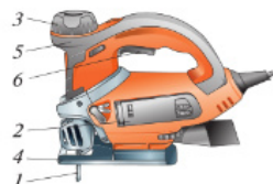
Рис. 5.58. Электрический лобзик: 1 — стальная пилка; 2 — электродвигатель с редуктором; 3 — регулятор; 4 — опорная лыжа; 5 — рукоятка; 6 — выключатель
