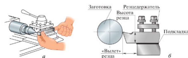
Рис. 5.12. Установка резца в резцедержателе: а — по вершине центра задней бабки; б — схема закрепления резца в резцедержателе
