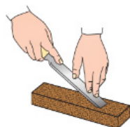
Рис. 4.12. Затачивание стамески на бруске
