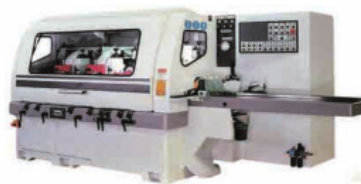
Рис. 4.34. Универсальный строгальный станок для фрезерования заготовок из древесины с четырёх сторон
