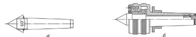
Рис. 5.9. Центры: а — центр повышенной износостойкости с конусом Морзе № 2; б — вращающийся центр для лёгких радиальных нагрузок
