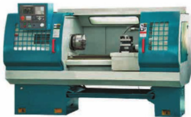
Рис. 5.13. Универсальный токарно-винторезный станок с ЧПУ российского производства
