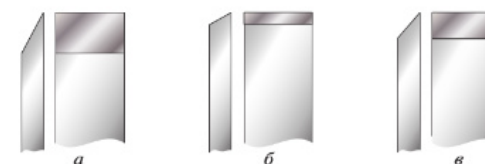
Рис. 4.7. Виды фасок: а — отлогая; б — крутая; в — нормальная
