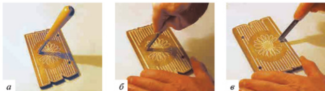
Рис. 8.24. Техника резьбы: а — начальное положение полукруглой стамески при наколке; б — приём наkolки; в — приём подрезки
