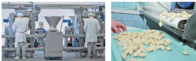
Рис. 7.27. Формованиепельменей в условиях производства (пельменный полуавтомат)
