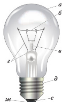
Рис. 10.2. Устройство лампы накаливания: а — стеклянная колба; б — нить накала; в — штабик; г — электроды; д — цоколь; е — изолятор; ж — центральный контакт
