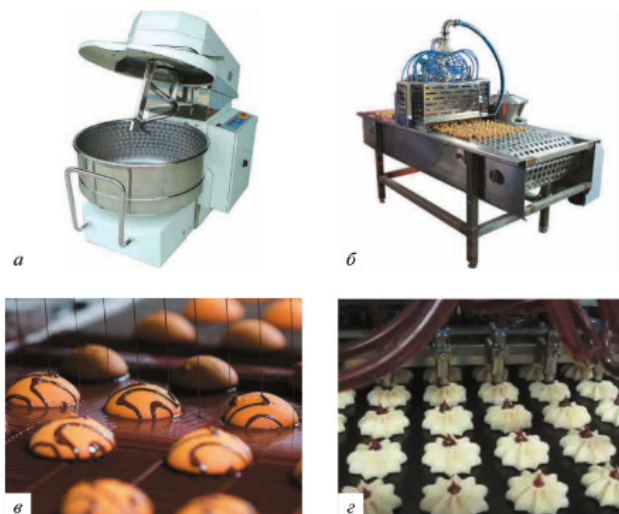
Рис. 7.17. Кондитерское оборудование: а — тестомесильная машина; б — оборудование для дозирования начинки (наполнение эклеров); в — глазировочное оборудование; г — отсадочная машина (печенье курабье)
