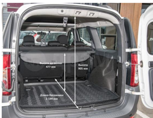
Рисунок 5. Размеры багажника «Лада Ларгус»
