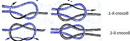
Один из вариантов контрольного узла:
