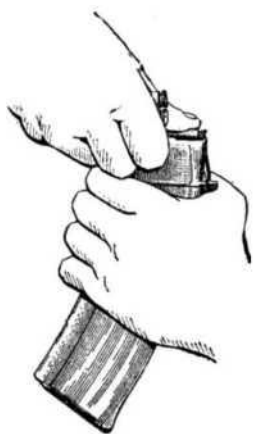
Снаряжение обоймы патронами: Снаряжение магазина патронами а - с переходником, б - без переходника
