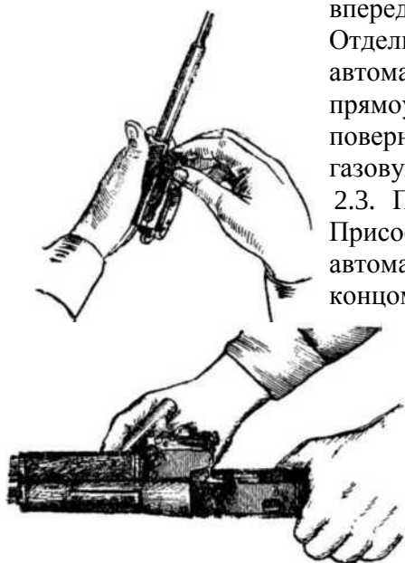
Поворот замыкателя газовой трубки с помощью пенала принадлежности
