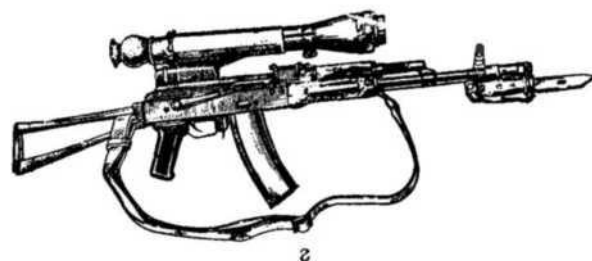
Общий вид 5,45-мм автомата Калашникова: а - с постоянным прикладом (АК74); б - со складывающимся прикладом (АКС74); в - с постоянным прикладом и ночным прицелом (АК74Н); г - со складывающимся прикладом и ночным прицелом (АКС74Н)
