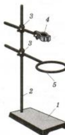
Рис. 1. Лабораторный штатив с лапкой и кольцом
