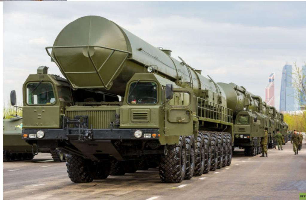
Комплекс «Ярс» должен прийти на замену «Тополю-М», его развертывание началось в 2010 году. Эта межконтинентальная баллистическая ракета несет несколько блоков индивидуального наведения с термоядерным зарядом, а ее максимальная дальность составляет 11 тысяч километров. По мощности эта ракета в 100 раз превосходит бомбу, которую США сбросили на Хиросиму в 1945 году.
