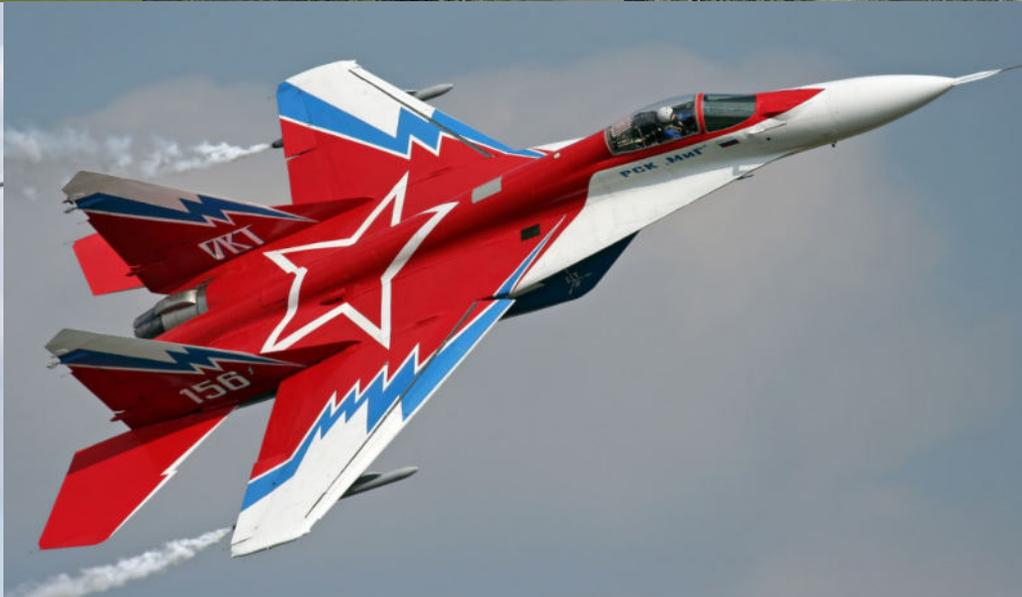
Истребитель МиГ-35. Многоцелевой истребитель МиГ-35 эффективен как в воздушном бою, так и при нанесении высокоточных ударов. Самолет развивает скорость до 2400 километров в час, несмотря на то, что он почти на треть тяжелее своего предшественника. МиГ-35 способен вести воздушные бои, уничтожать морские и наземные цели с большой дистанции и совершать разведывательные полеты.
